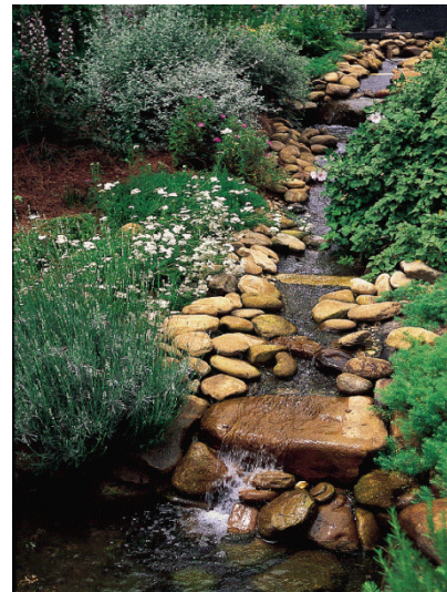
Figur 31. Variert utforming i og langs bekk, med muligheter for å komme ned til vannet. Lite fall på bekken gjør at terskler må bygges lave.
